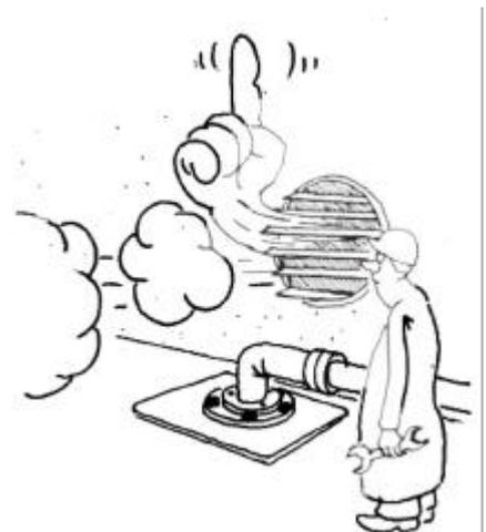
3.3 Wenn in der Nähe von Entlüftungsöffnungen oder Abblaseleitungen gearbeitet werden muß, so muß immer damit gerechnet werden, daß aus diesen Öffnungen Gase mit geringem oder fehlendem Sauerstoffanteil austreten.
